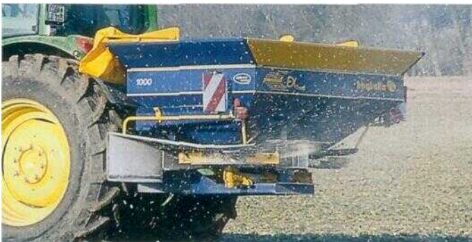
Der EX trend von Bogballe überzeugte mit den besten Ergebnissen. Er hatte bei allen Düngern eine gute bis sehr gute Streugenauigkeit.
