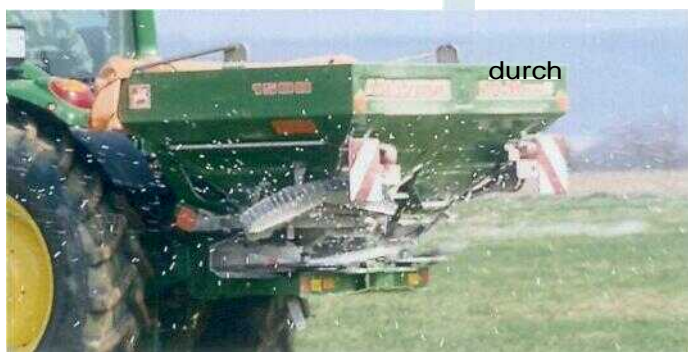
Der ZA-M maxIS von Amazone hatte schon bei Einstellung nach Tabelle durchweg eine durchschnittliche bis gute Streugenaugigkeit.
